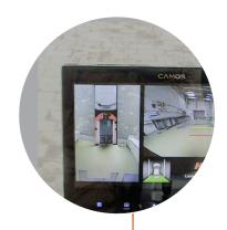
Sécurité accrue : Le système de caméra élargit l'angle de vision du conducteur à 270°.
