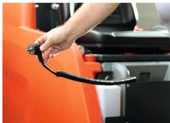
Le chargeur intégré permet de recharger la batterie sur n'importe quelle prise 220/230V standard.
