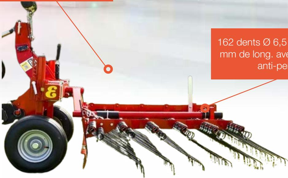
162 dents Ø 6,5 mm de 490 mm de long. avec dispositif anti-perte
