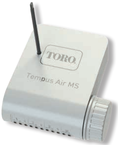
Module de programmation d'irrigation IP68 alimenté par batterie contrôlé par LoRa™ pour gérer de 1 à 6 vannes hydrauliques. Peut lire une entrée de capteur de pluie ou de débitmètre.
